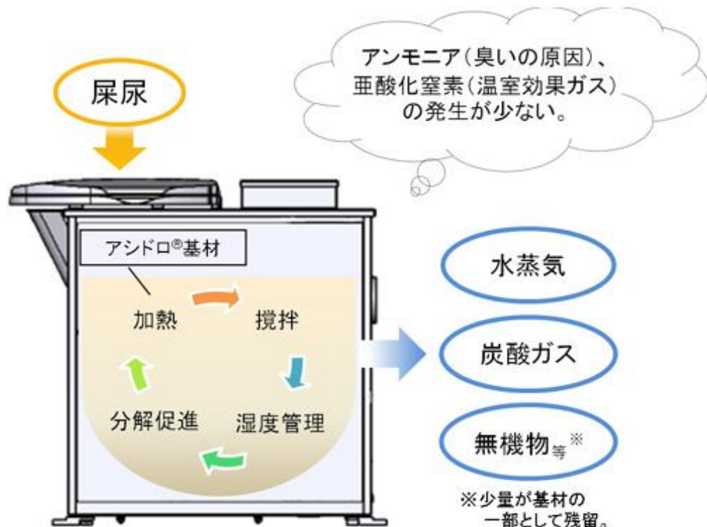
バイオトイレ用尿尿処理機による尿尿分解の模式図
